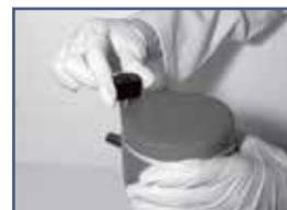
2. Das befüllte und fest verschlossene Mischgefäß wird von oben in den passenden Haltering eingesetzt. Der Kunststoff-Verriegelungsknopf des Halterings wird um 180° gedreht. Somit ist das Mischgefäß im Haltering arretiert.
