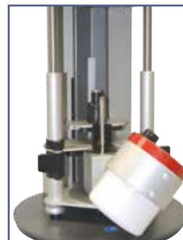
3. Der Haltering wird in den Anschlussstutzen des Getriebelockes gesteckt und solange gedreht (links oder rechts) bis das Kugellager des Halterings im Getriebelock einrastet. Überzeugen Sie sich auf jeden Fall vom kraftschlüssigen Sitz des Halterings im Getriebelock.
