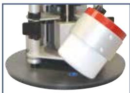
2. Den Getriebelock des Pulver-Mischsystems in den Aufnahmering so einstellen, dass der Anschlussstutzen des Getriebelockes nach vorne zeigt. Haltebrücke soweit nach unten drücken, bis sie kraftschlüssig auf dem Getriebelock aufsitzt. Danach unbedingt die Schlittenverriegelungen wieder schließen.
