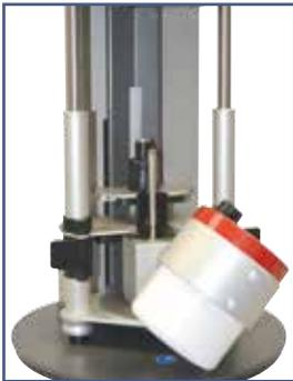
3. Der Haltering wird in den Anschlussstutzen des Getriebes gesteckt und solange gedreht (links oder rechts) bis das Kugellager des Halterings im Getriebeblock einrastet. Überzeugen Sie sich auf jeden Fall vom kraftschlüssigen Sitz des Halterings im Getriebeblock.
