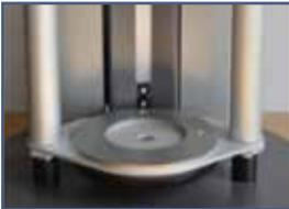
1. Den Haltering aus Aluminium (Best.-Nr. 26633) passgenau in den Haltering auf der Grundplatte des TOPITEC® Mischsystem einlegen. Die Haltebrücke des TOPITEC® Geräte-Schlittens soweit nach oben ziehen, dass der Getriebelock in den Aufnahmering eingesetzt werden kann.
