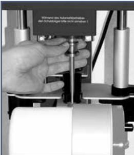
3. Heben Sie mit einer Hand den Geräte-Schutzbügel bis zum Anschlag an und ziehen mit dieser Hand auch gleichzeitig den Verriegelungsring der Geräte-Antriebswelle hoch; mit der anderen Hand drücken Sie jetzt die „▼“ Taste und halten diese gedrückt. Der Geräteschlitten fährt in die Endposition zurück. Im Gerätedisplay wird wieder der Grundmodus angezeigt. Die Verriegelung am Haltering wird geöffnet und das Mischgefäß kann entnommen werden.
