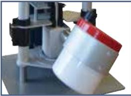
2. Den Getriebelock des Pulver-Mischsystems in den Aufnahmering so einstellen, dass der Anschlussstutzen des Getriebelockes nach vorne zeigt. Haltebrücke soweit nach unten drücken, bis sie kraftschlüssig auf dem Getriebelock aufsitzt. Danach unbedingt die Schlittenverriegelungen wieder schließen.
