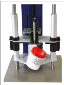
TOPITEC® Pulvermischsystem Das Pulvermischsystem eignet sich zur schnellen und einfachen Herstellung von Pulver- und Granulatmischungen in den Gefäßgrößen 100 g, 500 g und 1.000 g und bietet eine große Zeitersparnis bei der Herstellung größerer Mengen. Gefäße dürfen allerdings nur bis zur Hälfte mit Inhalt gefüllt sein. Perfekt eignet sich das Pulvermischsystem zur Herstellung des Inhaltes für Kapseln. Durch die luftdichte Verarbeitung vermeiden Sie das Austreten von Pulverpartikeln. Das schützt den Rezeptar und das Produkt. Best.-Nr. 025720
