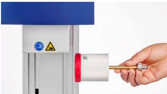
Abb. 18: Kamera scannt Matrixcode vom Krukenkörper
