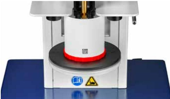
Abb. 8: Korrekt eingespannte Kruke
