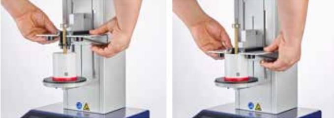
Abb. 27: Verriegelung der Brücke
