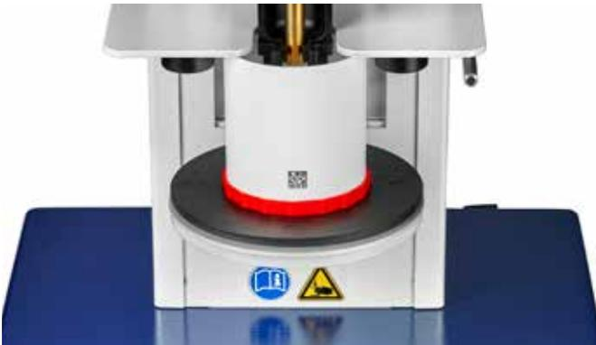
Abb. 28: Korrekt eingespannte Kruke
