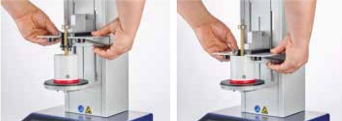
Abb. 7: Verriegelung der Brücke
