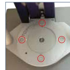
4. Beim Einsetzen in den fest montierten Aufnahmerring des TOPITEC® Systems darauf achten, dass die Defekturdose richtig sitzt (siehe rote Kennzeichnung).
