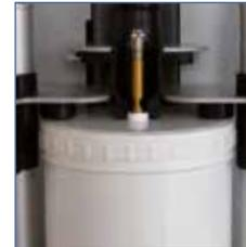
7. Die Verriegelungsbrücke so weit nach unten schieben, dass sowohl das Hubbodendistanzstück als auch die schwarzen Distanzstücke der Verriegelungsbrücke rechts und links **fest** auf dem Mischdeckel aufliegen.
