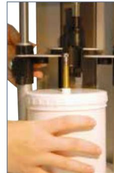
5. Die Verriegelungsbrücke nach oben ziehen und die Dose mit Mischwerkzeug in die Werkzeugwellenführungen „einführen“. Beim Einsetzen darauf achten, dass die Defektdose mit den 4 Standfüßen richtig im Aufnahmering sitzt.
