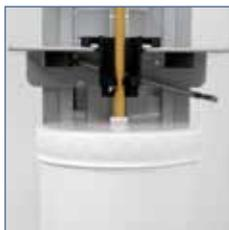
5. Die Verriegelungsbrücke nach oben ziehen und die Dose mit Mischwerkzeug in die Werkzeugwellenführungen „einführen“. Beim Einsetzen darauf achten, dass die Defektdose mit den 4 Standfüßen richtig im Aufnahmering sitzt.
