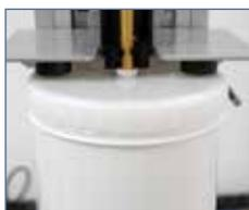
7. Die Verriegelungsbrücke so weit nach unten schieben, dass sowohl das Hubbodendistanzstück als auch die schwarzen Distanzstücke der Verriegelungsbrücke rechts und links **fest** auf dem Mischdeckel aufliegen.
