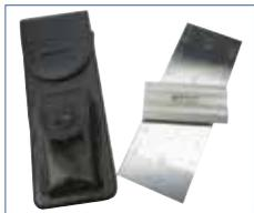
Um die Partikelgröße einer Suspensionsrezeptur genauer zu bestimmen, empfehlen wir die Überprüfung mit dem Grindometer (Best.-Nr. 026220). Partikelgrößen zwischen 0 und 100 µm können mit dem Grindometer gemessen und die Rezeptur dahingehend überprüft werden.
