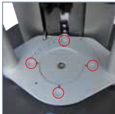
4. Beim Einsetzen in den fest montierten Aufnahmering des TOPITEC® Systems darauf achten, dass die Defektdose richtig sitzt (siehe rote Kennzeichnung).
